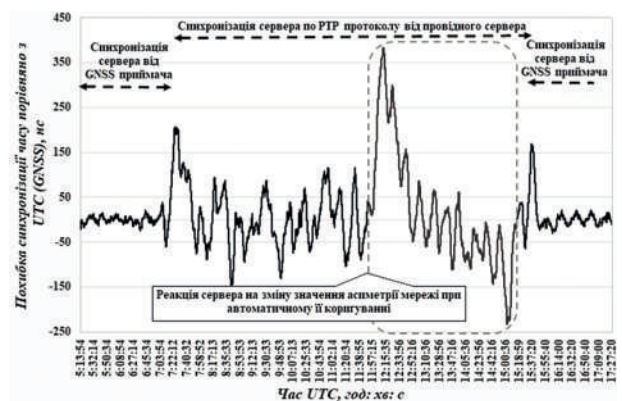
Рис. 11. Залежність похибки синхронізації часу веденого РТР сервера у випадку зміни значення асиметрії
