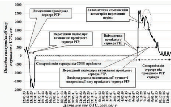
Рис. 7. Максимальна похибка синхронізації часу веденого RTP сервера при вимкненні та увімкненні провідного сервера RTP
