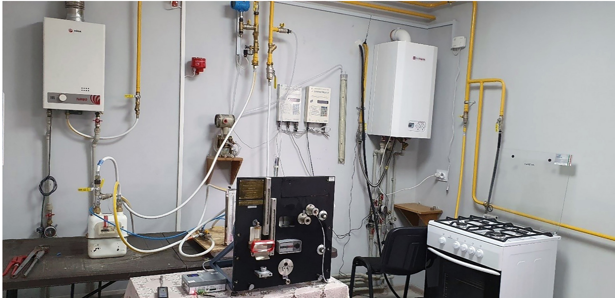
Рис. 7. Загальний вигляд зібраного стенду для проведення досліджень в умовах імітаційного полігону газоспоживаючого обладнання
