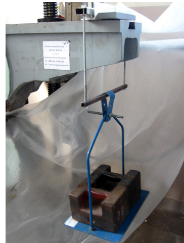
Рис. 6. Схема навантаження пристрою для калібрування
