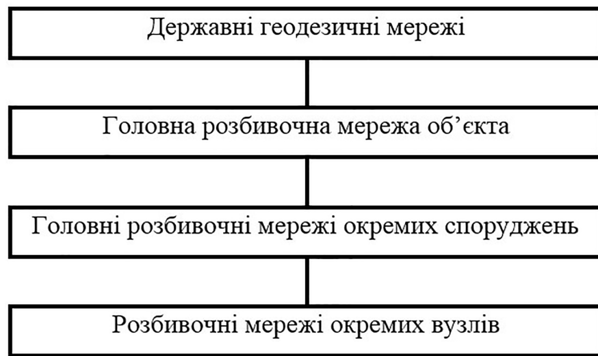
Рис. 1. Структурна схема розбивочних мереж
