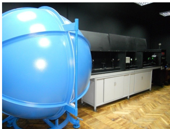
Рис. 1. Фотография государственного первичного эталона единицы светового потока – люмена
